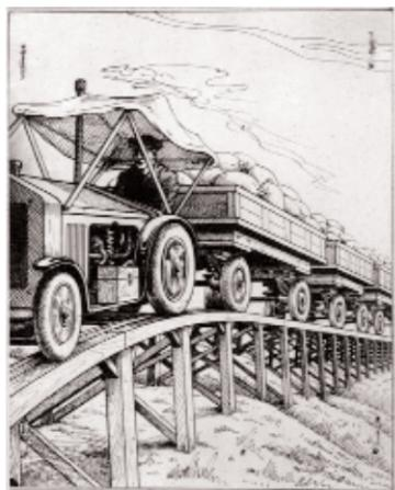
To je bio spoj druma i železničke pruge: neka vrsta betonskog korita na stubovima duž kojeg bi vozila klizila betonskim šinama. Vuču su obezbeđivali traktori, tegljači sa propelerima (i
